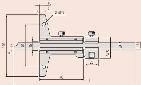
Capacité jusqu'à 300 mm
